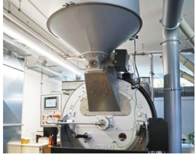
Mit Erdgas werden die Kaffeebohnen in der Rösttrommel erhitzt. Eine Röstung dauert 12 bis 14 Minuten – je nach Mischung
